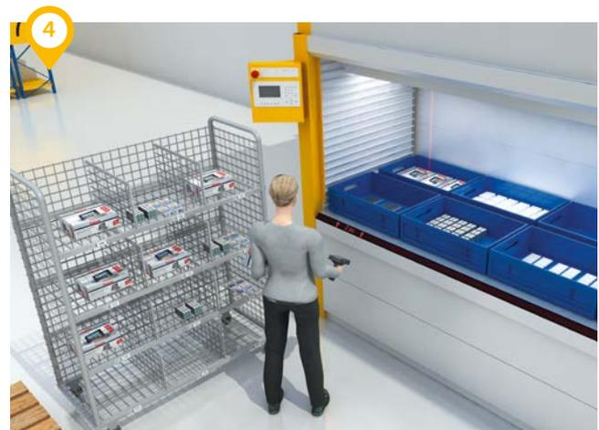
Das **Put-to-Light-Modul** erhöht die Prozesssicherheit, indem der Mitarbeiter bei der Einlagerung durch visuelle Hinweise geleitet wird.
