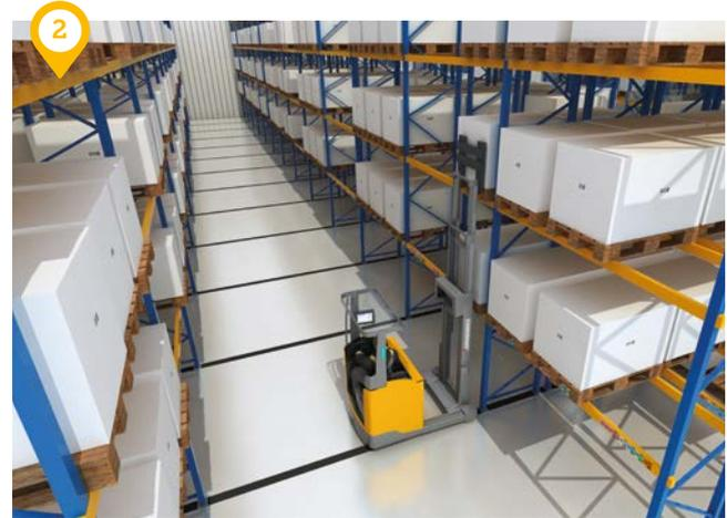
Nach der Vereinnahmung kann der Einlagerauftrag automatisch oder durch den Mitarbeiter systemgeführt erstellt werden. Danach wird im Zuge der Einlagerung bspw. ein Verschieberegale durch das Jungheinrich WMS angesteuert und der entsprechende Zielgang geöffnet. Weitere Lager-typen wie Einfahr- oder Einschubregale, Blocklager, Durchlauf- oder Kragarmregale können im Jungheinrich WMS ebenfalls problemlos abgebildet werden.
