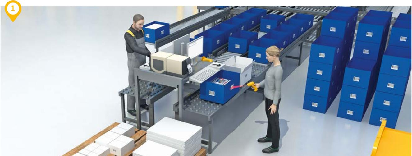
Automatische Kleinteilelager (AKL) kommen immer dann zum Einsatz, wenn es um hohe Leistungsanforderungen geht. Die Steuerung und Optimierung der AKL erfolgt vollständig durch das Jungheinrich WMS. In AKLs findet sowohl die Befüllung als auch die Kommissionierung an vorgelegerten Arbeitsplätzen statt. Bei der Kommissionierung kann bspw. durch den Einsatz des Moduls **Pick&Pack** die Ware direkt beim Kommissioniervorgang in eine Versand-
