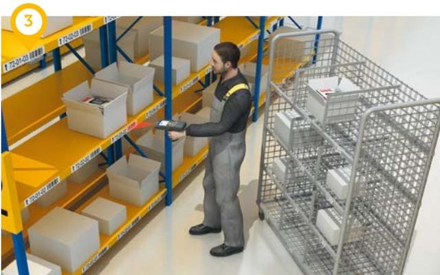
Sie kommissionieren mit einem **Funkterminal**? Dann erhalten Ihre Mitarbeiter alle relevanten Informationen für die Auslagerung in übersichtlicher Form beleglos auf dem Gerät – und das in Echtzeit. Der integrierte Scanner steigert die Effizienz bei der Informationserfassung.
