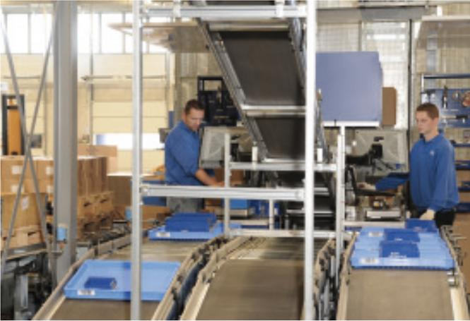
**Bild 4** An den zehn multifunktionalen Kommissionier-Arbeitsplätzen können sowohl Kanban-Aufträge in verschiedene Kundenbehälter ...
