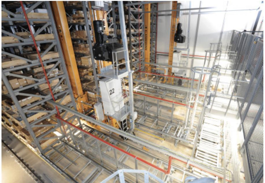
**Bild 1** Das fünfpassige automatische Palettenhochregallager dient als Nachschublager sowie als Kommissionierlager für große Auftragspositionen.
