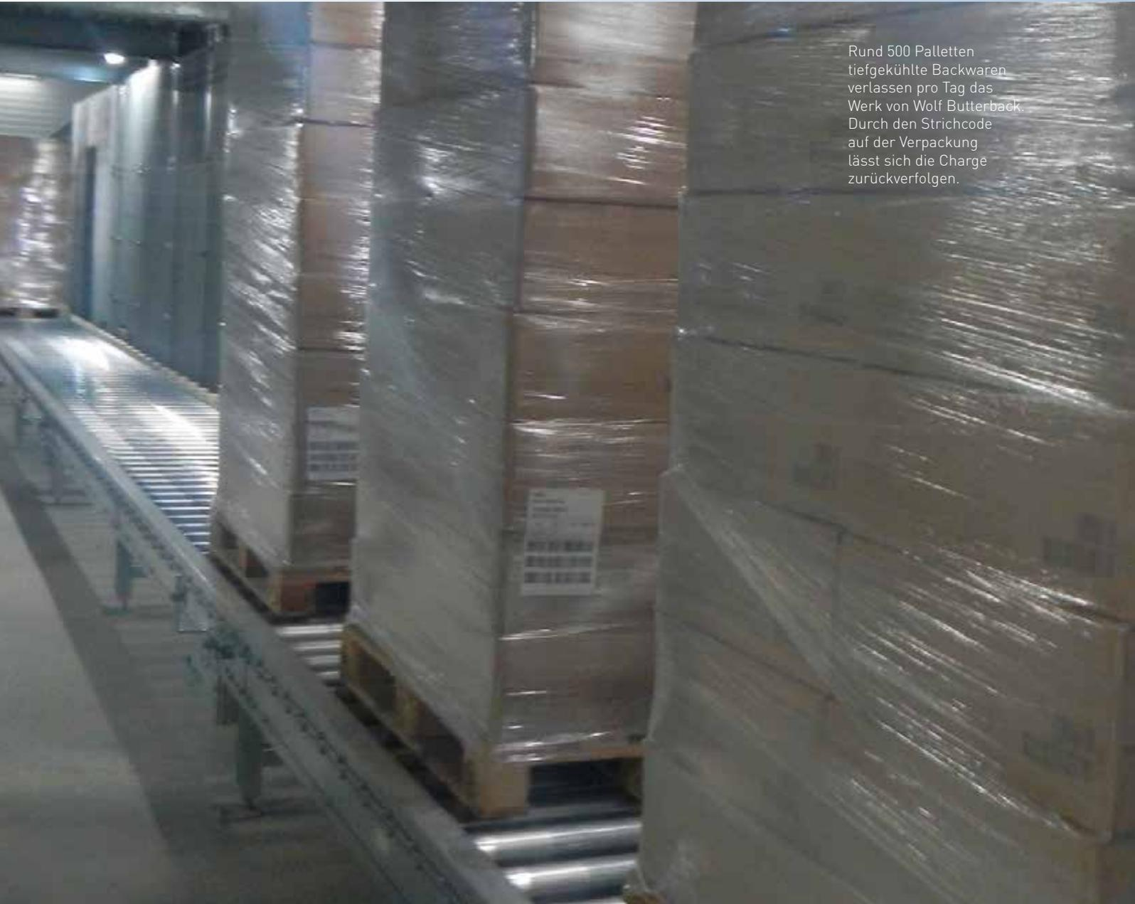
Rund 500 Paletten tiefgekühlte Backwaren verlassen pro Tag das Werk von Wolf Butterback. Durch den Strichcode auf der Verpackung lässt sich die Charge zurückverfolgen.
