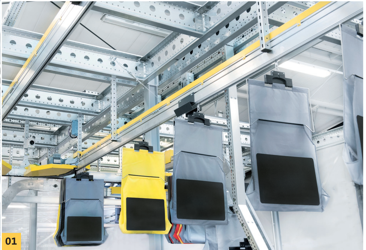
Lagerware lässt sich durch einfache Übergabe in die Taschen mit dem System SSI Carrier sequenziert und nach Kundenaufträgen sortiert automatisch zu einem Auftrag zusammenführen
