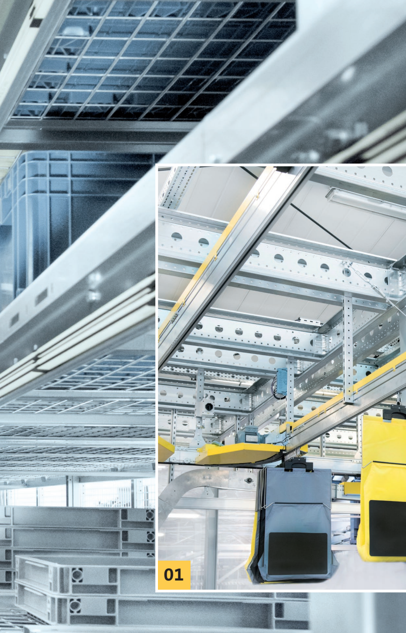
Lagerware lässt sich durch einfache Übergabe in die Taschen mit dem System SSI Carrier sequenziert und nach Kundenaufträgen sortiert automatisch zu einem Auftrag zusammenführen
