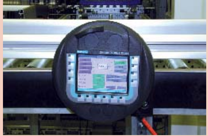
Bild 4: Komfortable Bedienung der Steuerungstechnik mit Mobile Panels
