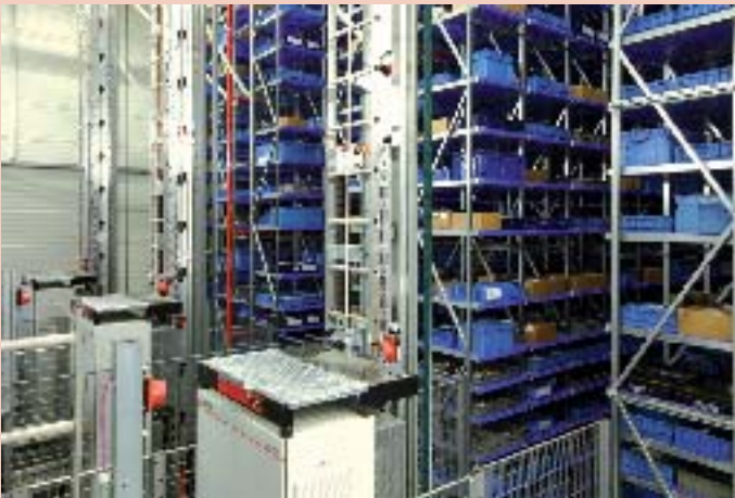
Bild 1: Das Automatische Kleinteilelager bietet Platz für mehr als 13 000 Tablare
