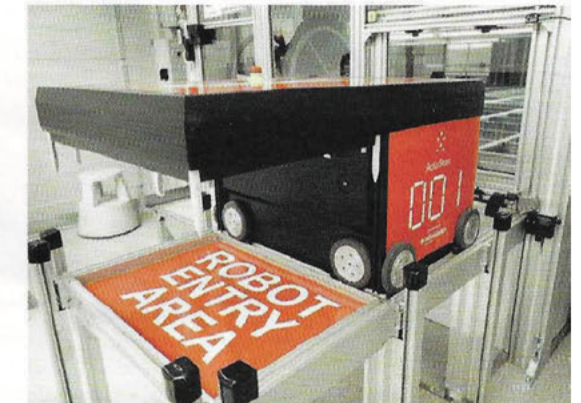
03 An der „Robot Entry Area“ starten die autonomen Transportroboter und gelangen über den Grid zur Auftragsposition im Kleinteilelager
