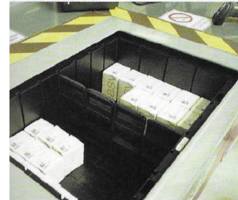
01 Die Autostore-Anlage ist für 2 610 Behälter ausgelegt, die sich mithilfe von Trenneinlagen für den Transport unterschiedlicher Artikel unterteilen lassen
