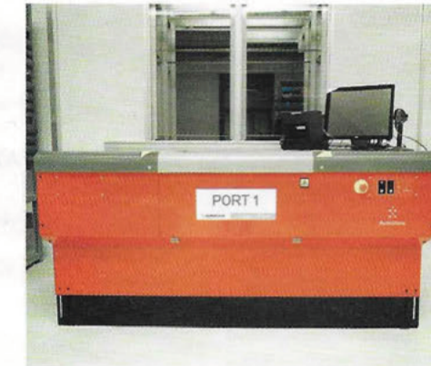
02 Das automatische Kleinteilelager integriert Kommissionierstationen an denen Wareneingänge und Kommissionieraufträge bearbeitet werden
