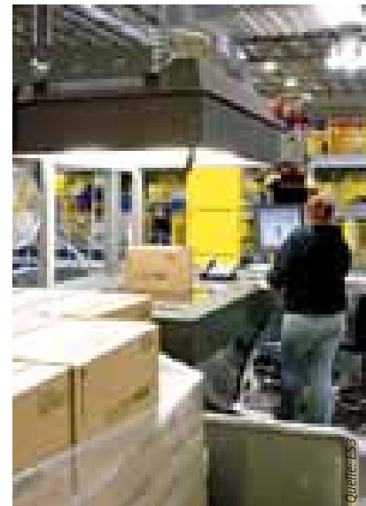
Der Teach-In-Prozess im Distributionszentrum von ES3 ist wichtig für die IT-Stammdatenerfassung, da Maße, Gewicht und Aussehen der Ware parallel erfasst und als Grundmuster in der Artikeldatenbank hinterlegt werden.
