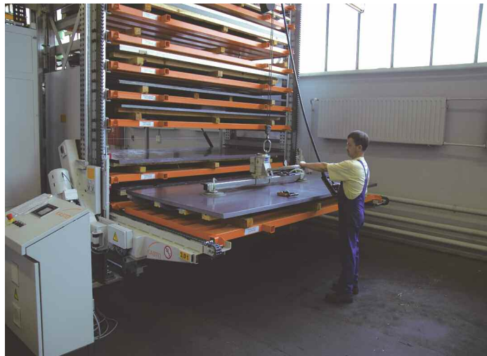
Die einfache Materialentnahme erfolgt mittels Kran und Vakuum-Traverse und ermöglicht sicheres Arbeiten
