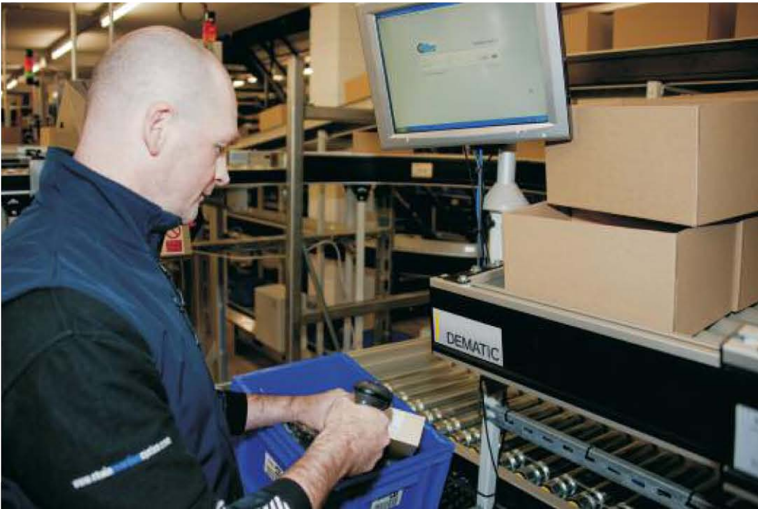
Neben der mobilen Pick-by-Voice-Lösung sind Scanner, Touchscreens, Drucker und Pick-by-Light-Anlagen im Einsatz
