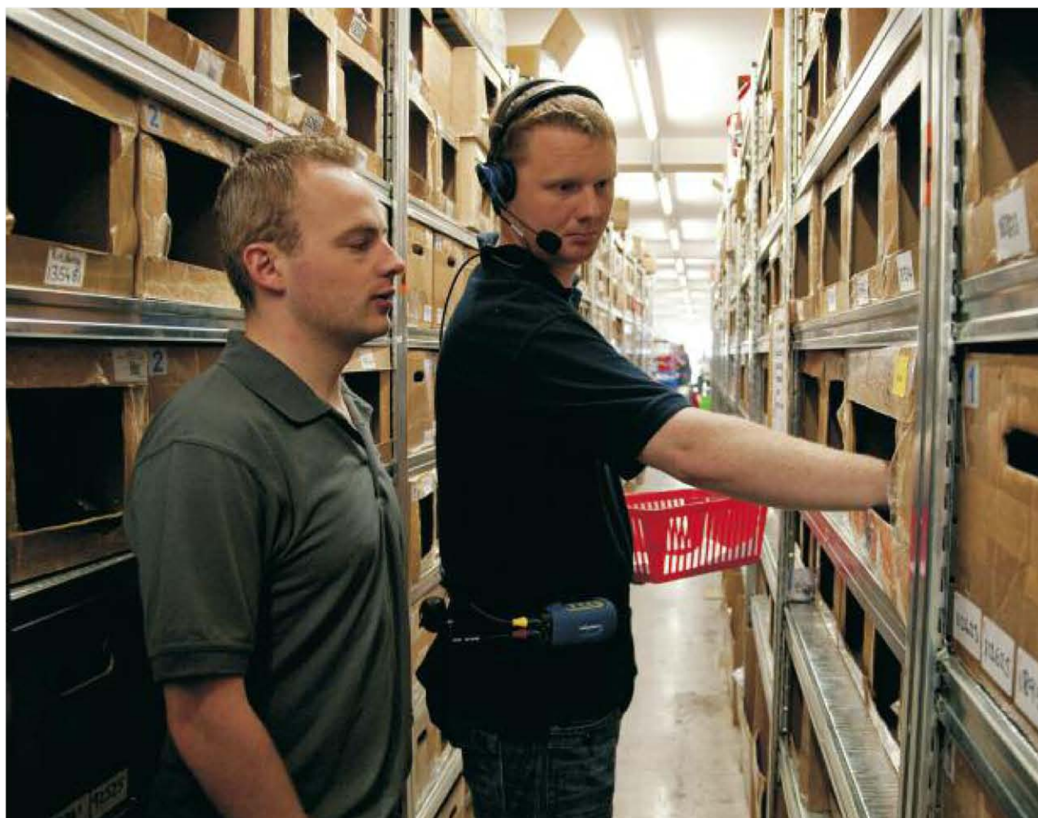
Pick-by-Voice: Das Warehouse-Management-System von Dematic steuert die Logistikprozesse bei CRC, der sprachbasierten Kommissionierung
