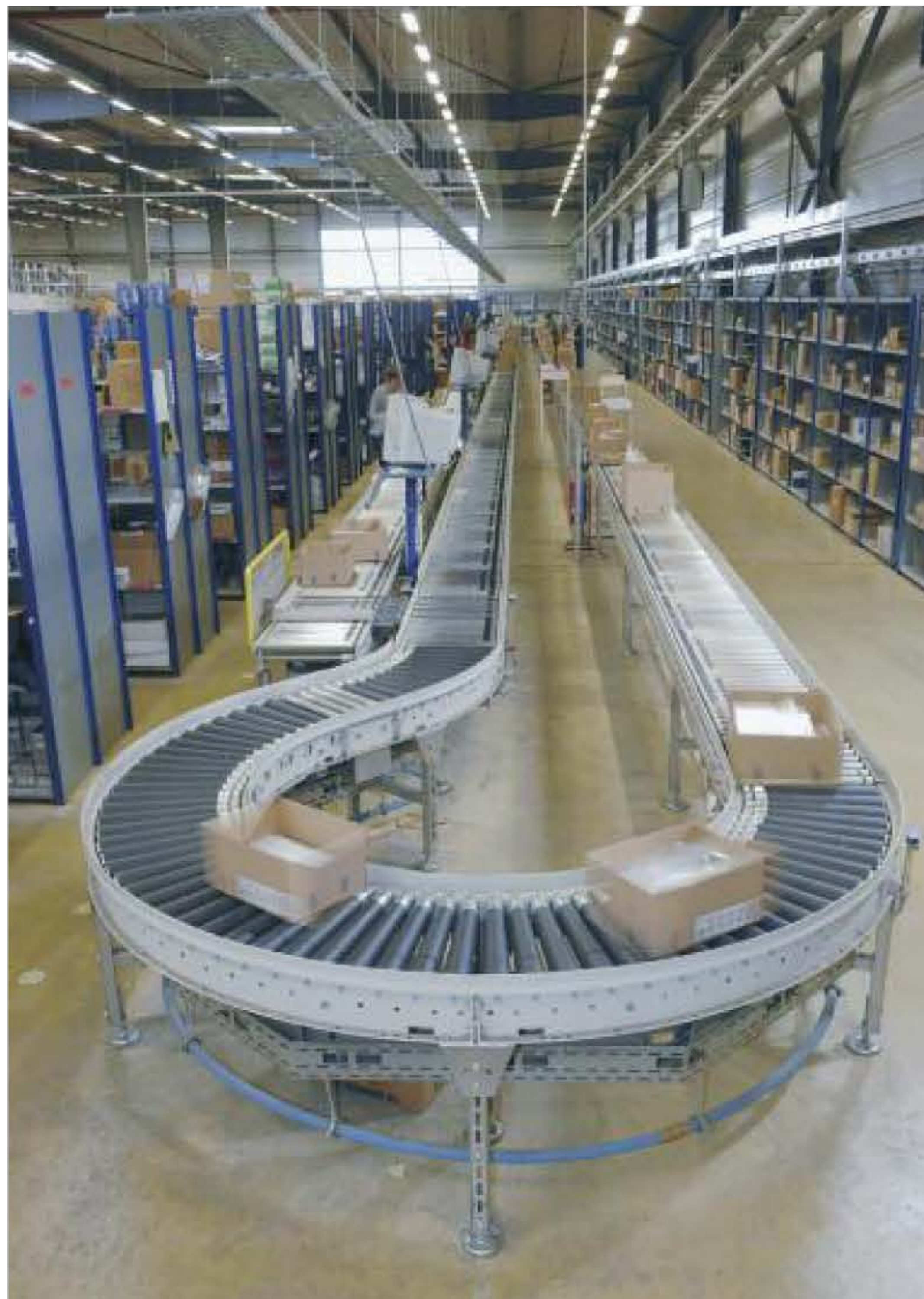
Die kommissionierten Artikel werden durch die automatische Förderanlage transportiert
