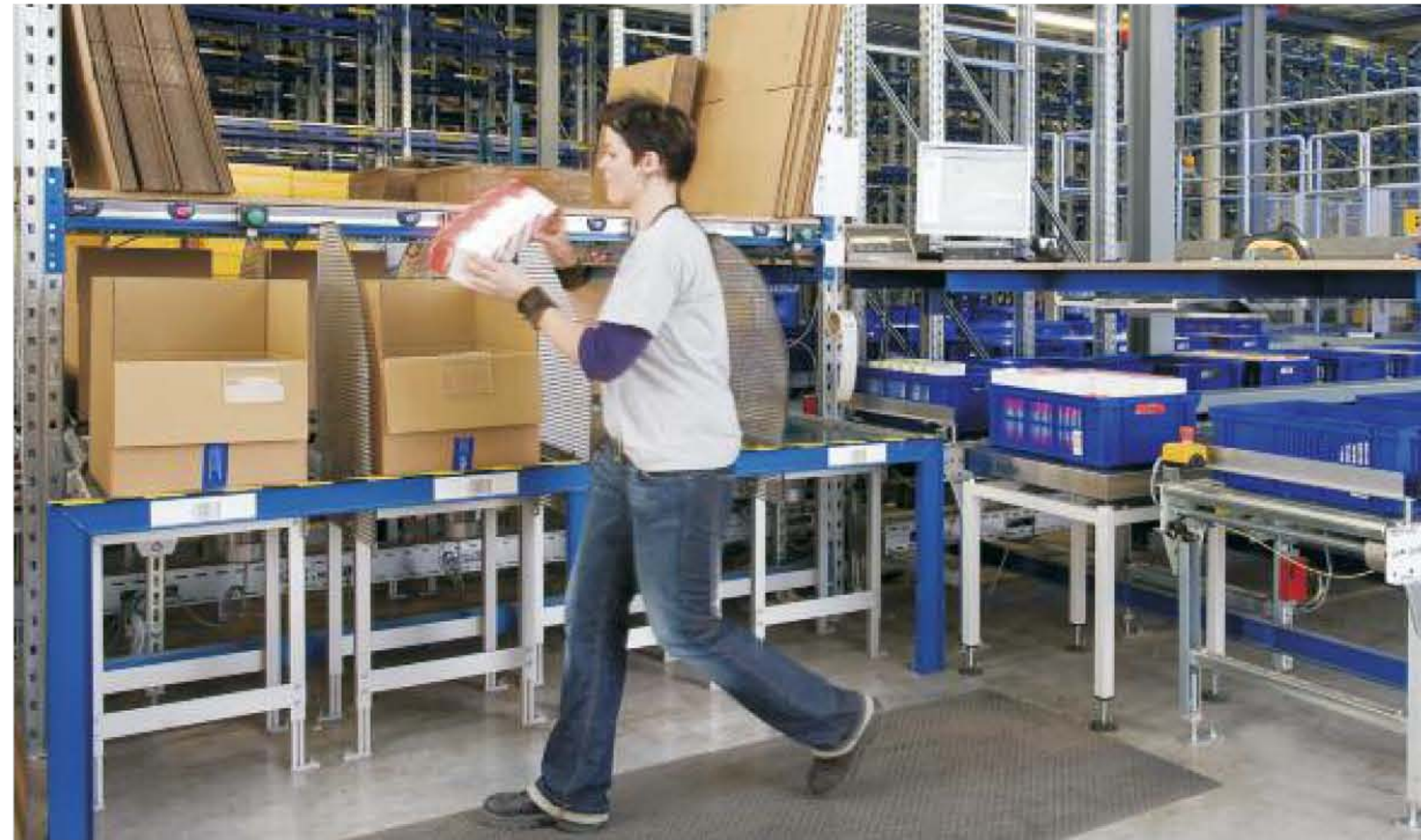
Jeder der 20 Arbeitsplätze ist mit Touchscreen, Barcode-scanner sowie Label- und Dokumentendrucker ausgestattet
