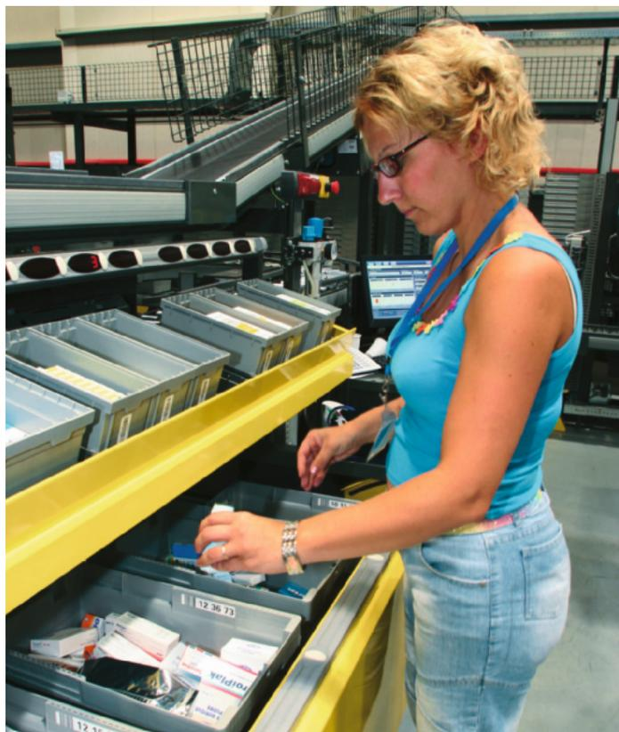
**Zur Frau kommt die Ware beim OSR-System von Knapp und ermöglicht so eine Leistung von bis zu 1000 Zeilen/h**
