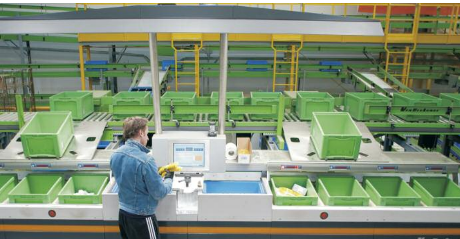
Behälterbasierter Hochleistungskommissionierarbeitsplatz Pick & Ease von Vanderlande Industries beim Unternehmen Sacchi
