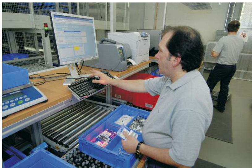
Kommissionierarbeitsplatz von Viastore in einem automatischen Kleinteilelager. Die relevanten Pickzonen werden dabei beleuchtet
