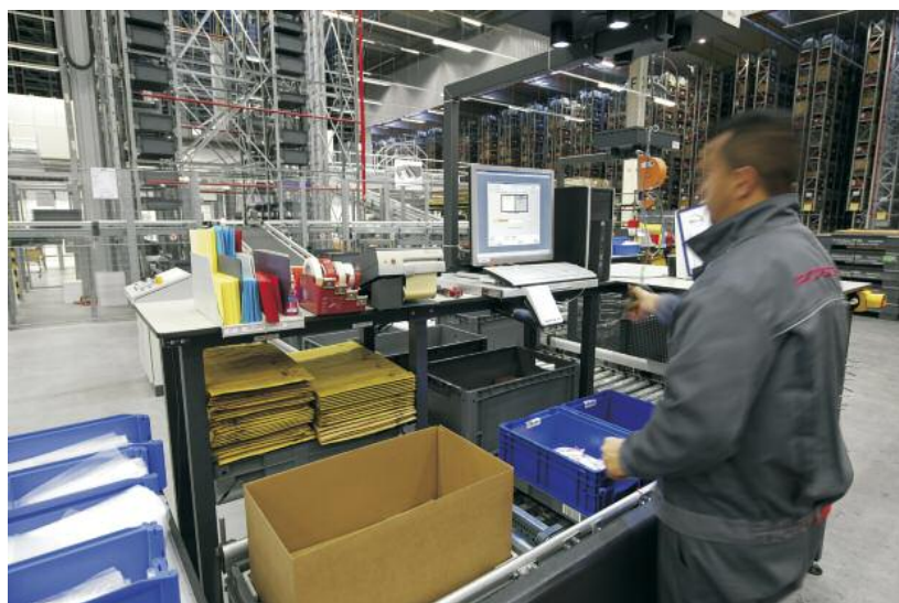
Kommissionierarbeitsplatz im Logistikzentrum von Porsche. Die Witron-Logistiksoftware gibt visuelle Unterstützung beim Pickprozess
