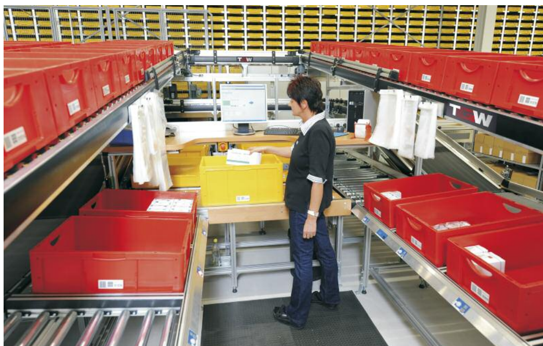
Dynamische Kommissionierarbeitsplätze, wie dieser Behälterpickplatz von TGW, können je nach Auslastung besetzt werden und gewährleisten höchste Durchsatzleistungen
