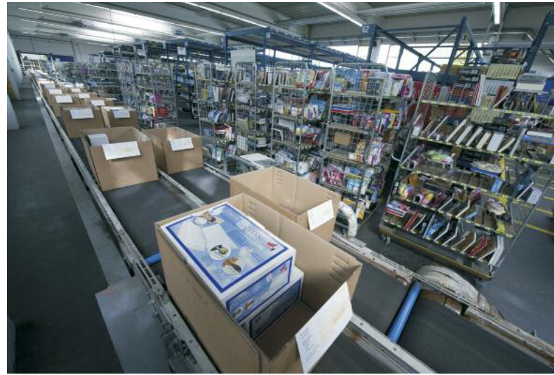
Aus dem Pick-Wagen wird die Ware in Versandkartons gepackt. Diese laufen auf einem Förderer an der Pickzone vorbei
