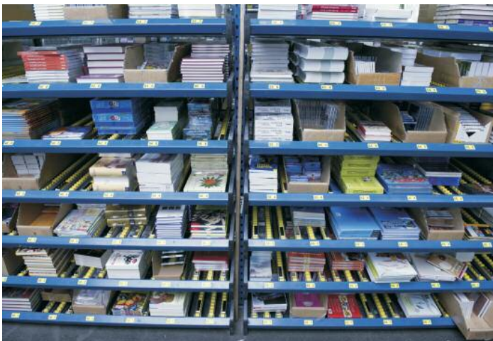
In der Kommissionierzone werden die Artikel in Durchlaufregalen gepuffert und auftragsbezogen kommissioniert
