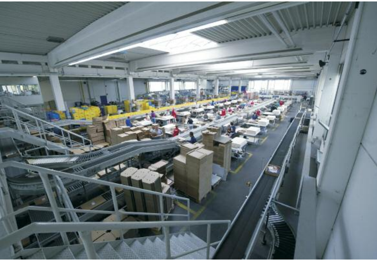
Die Kartons werden auftragsbezogen manuell aufgerichtet und mit einer Nummer versehen
