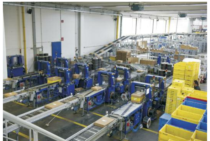
Um die Stabilität der Pakete zu gewährleisten, werden diese in der Packerei automatisch umreift
