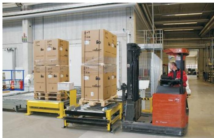
**Für die Ganzauslagerung bestimmte Paletten werden mit Hilfe von Gabelstaplern an den Abnahmestellen aufgenommen**
