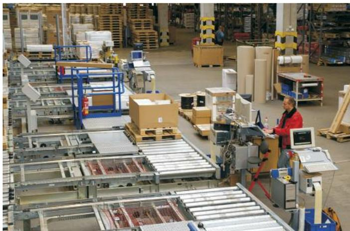
**Angeforderte Paletten werden im Logistikzentrum von Obeta über Auslagerstiche und die Fördertechnik den integrierten Kommissionierarbeitsplätzen zugeführt**
