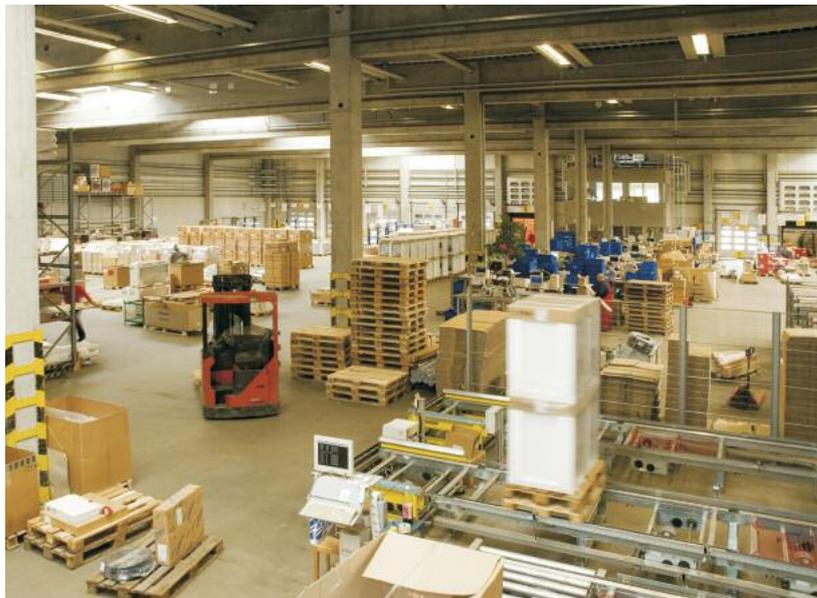
Angeforderte Paletten werden über Auslagerstiche und die Fördertechnik den integrierten Kommissionierarbeitsplätzen zugeführt
