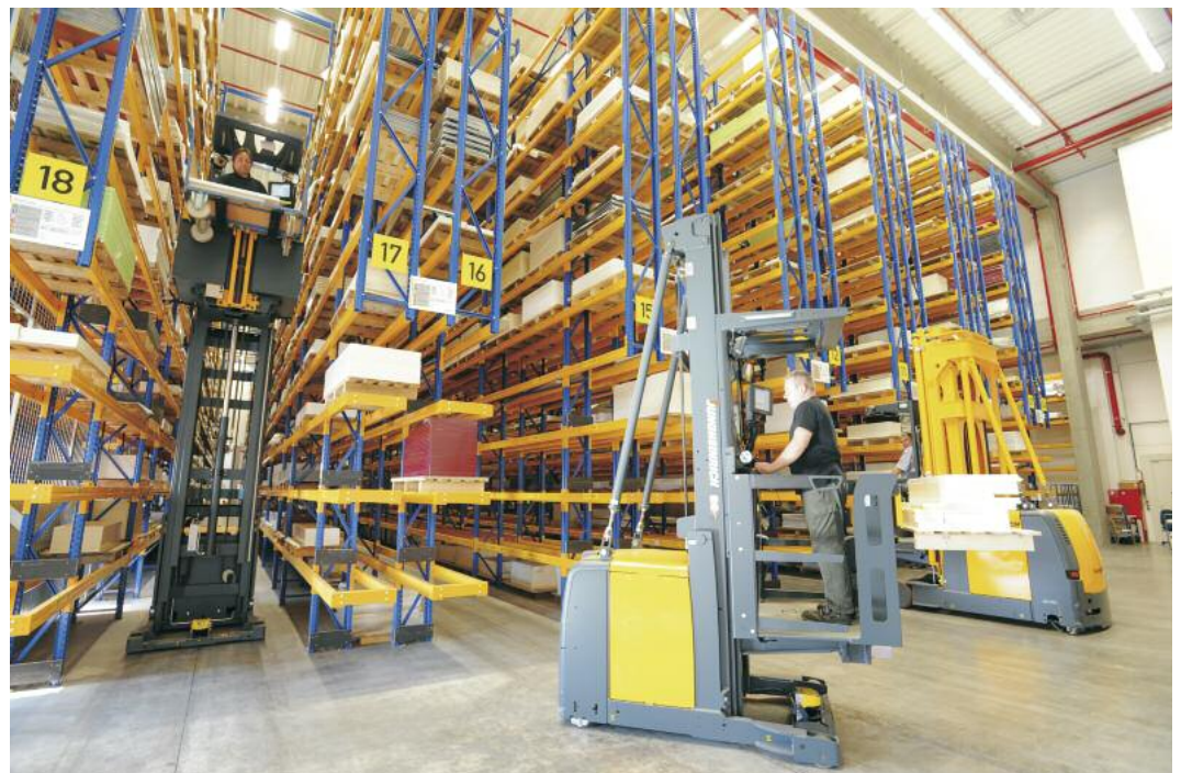
Jungheinrich hat für ‚Bau-for-mat Küchen‘ ein Gesamtkonzept implementiert. Es umfasst ein Schmalganglager mit Flurförderzeugen, Softwaresteuerung, Lagernavigation und WLAN
