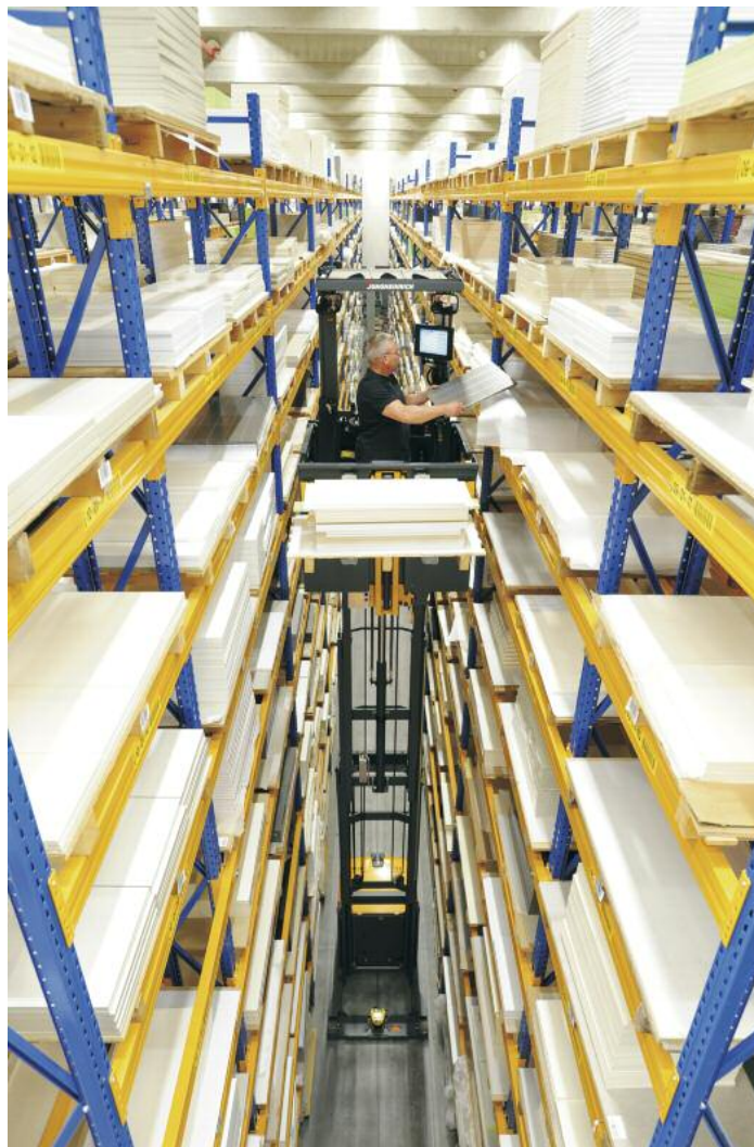
Im Schmalganglager werden zwei Vertikalkommissionierer EKS 312 (Bild) sowie ein Hochregalstapler EKK 513k eingesetzt
