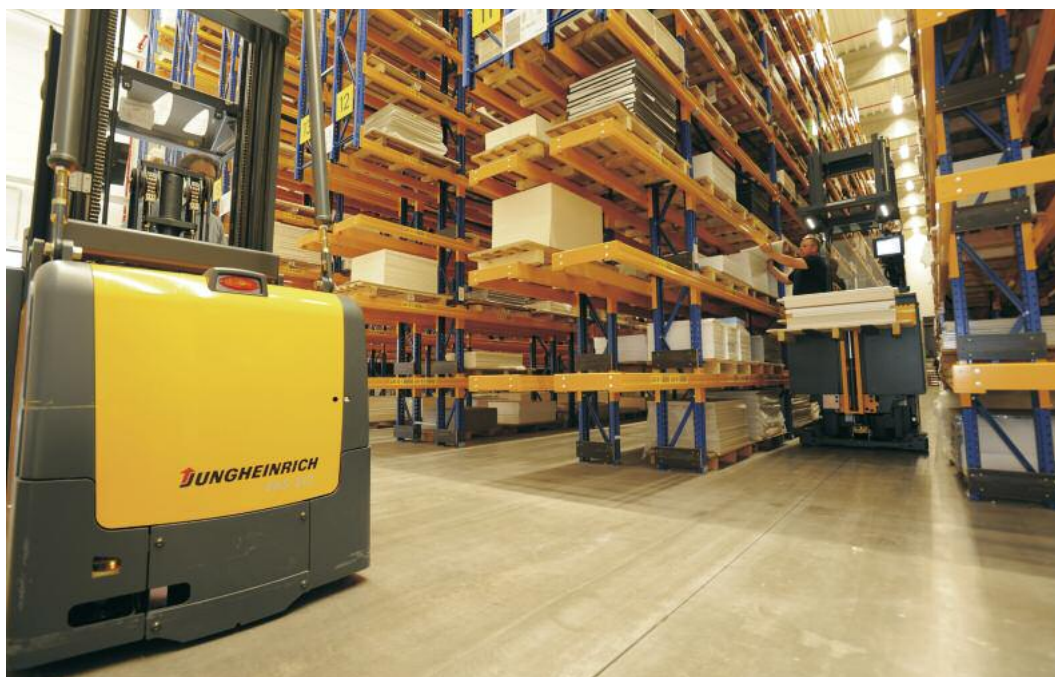
Die Flurförderzeuge navigieren im Lager mit Hilfe von in den Boden eingelassenen RFID-Transpondern. Die Positionen der Fahrzeuge werden dem WMS permanent kommuniziert
