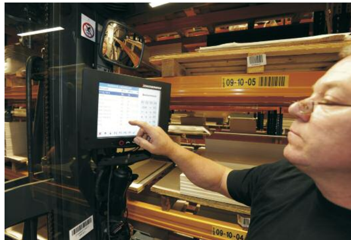
Gesteuert wird das Lager durch das Warehouse-Management-System, das über WLAN mit den Staplerterminals kommuniziert
