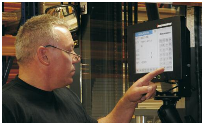
Um höchste Kommissionierqualität zu erzielen, wird dem WMS jede Aktion per Touchscreen oder Scanner bestätigt
