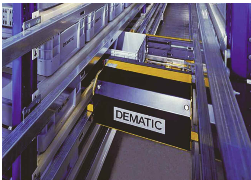
Autonomes Shuttle-Fahrzeug, die Kerneinheit der Multishuttle-Technologie für automatisierte Behälterlager und die integrale Fördertechnik
