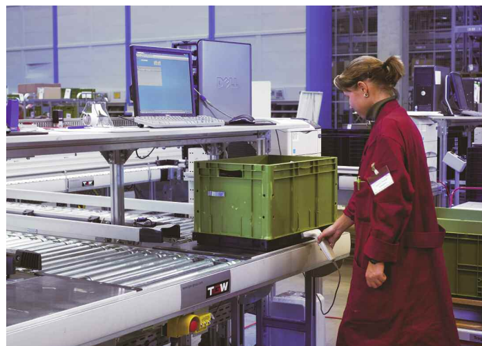
Ergonomisch und multifunktionell gestaltet wurden die Kommissionier-Arbeitsplätze bei Hella
