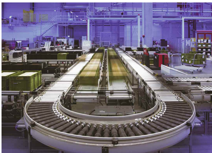
Ein Fördertechnik-Loop verbindet bei Hella die 13 Arbeitsplätze und sorgt für die richtige Zuteilung der Waren
