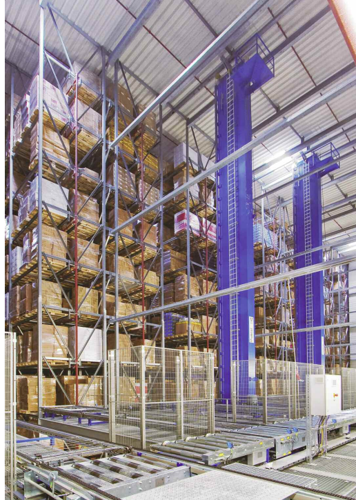
Automatisches Hochregallager von Mlog
