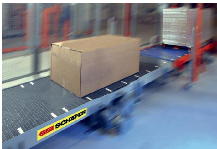
Die Kunststoffelemente der Fördertechnik sind längsseitig ineinander verzahnt und über ihre gesamte Breite zu einem umlaufenden Transportband verknüpft
