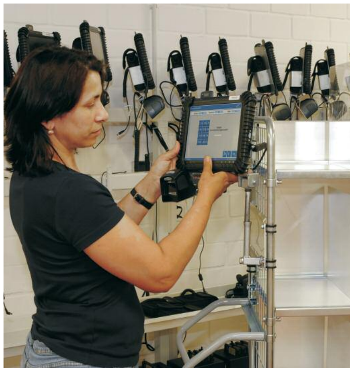
Nur 2,5 kg wiegt ein Tablet-PC mit Batterie, Scanner und Aufsteckmechanik. Er wird auf andere Wagen umgesteckt
