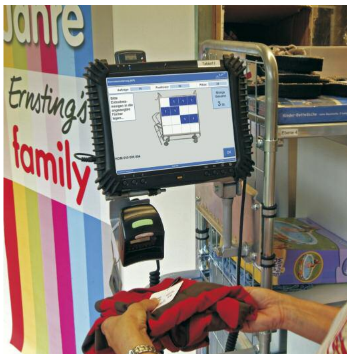
Vor dem Kommissionieren ordnet der Picker die Fächer im Wagen an. Logstar errechnet, wie viele er für eine Order benötigt
