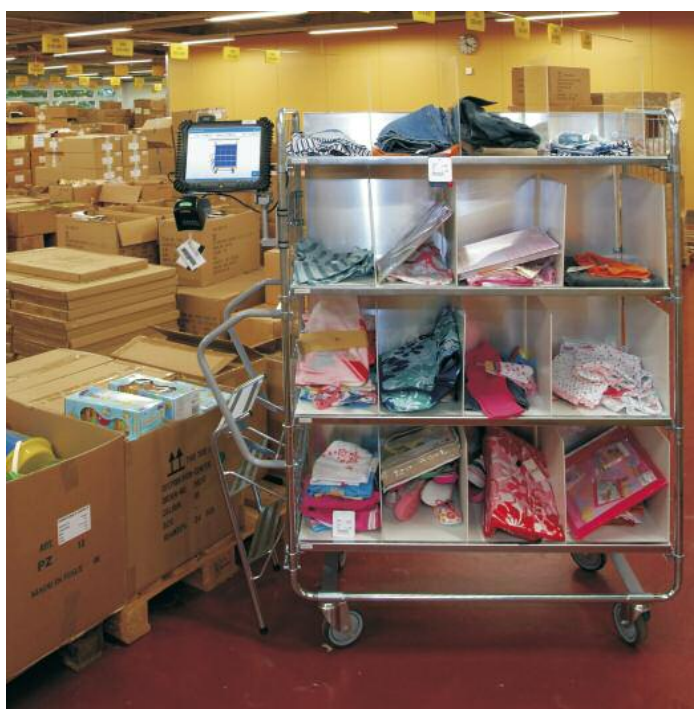
Gut verfahrbar ist der Rollwagen, der über eine sehr flexible Fächereinteilung mit verschiebbaren Zwischenwänden verfügt
