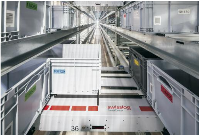
Das Shuttle ‚Smartcarrier‘ von Swisslog. Shuttle-Läger weisen eine hohe Dynamik auf und sind gut skalierbar
