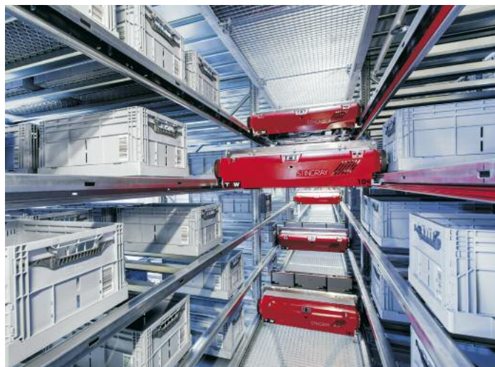
Shuttle-Systeme, wie der Stingray von TGW, zeichnen sich durch eine hohe Dynamik und Skalierbarkeit aus
