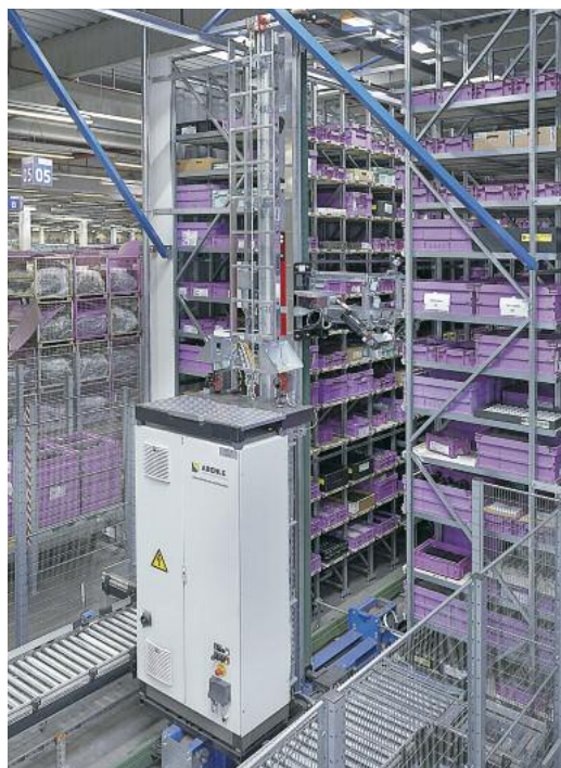
Automatisches Kleinteilelager von Aberle beim Logistikdienstleister Schenker in Eching
