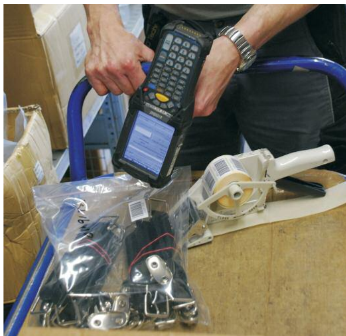
Mobilcomputer Motorola MC9090-G mit Scanner für die mobile Datenerfassung aller gängigen eindimensionalen Codes
