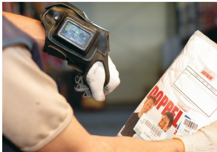
Entnahme- und Scannvorgang mit einem MDE-Handschuh mit integriertem Datenfunk, Scanner und optischer Anzeige
