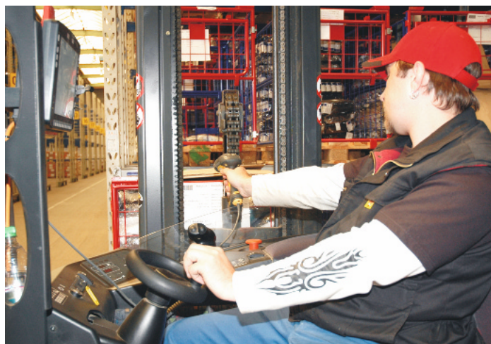
Ein- und Auslagerungen werden, wie hier vom Stapler aus, per Barcodescan bestätigt und an den Rechner übermittelt
