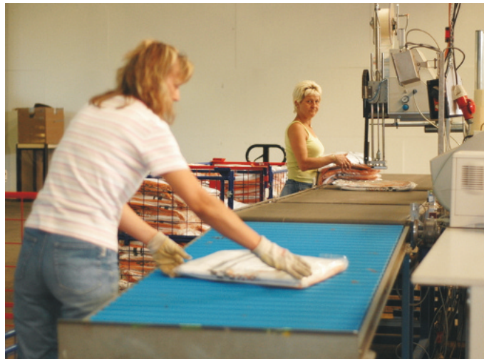
Im Wareneingang werden eintreffende Güter automatisch mit einer Kontrollwaage gewogen und sofort ausgezeichnet
