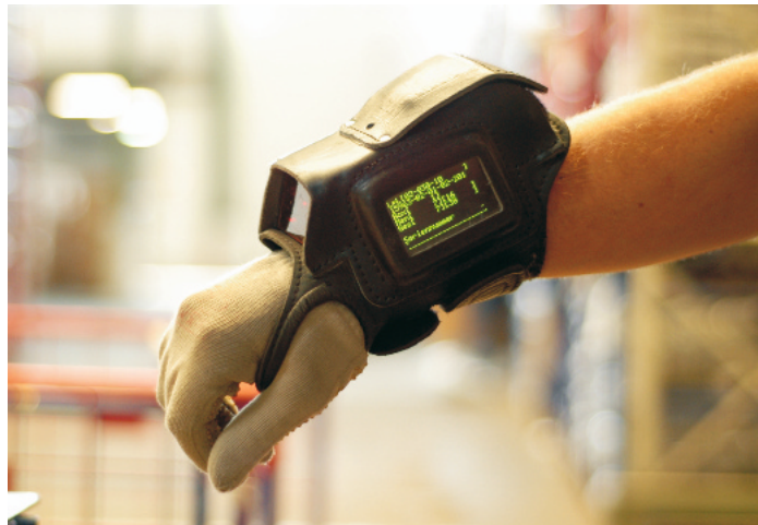
Der MDE-Handschuh stellt ein Datenfunkterminal dar, das mit dem Lagerrechner über das WLAN kommuniziert
