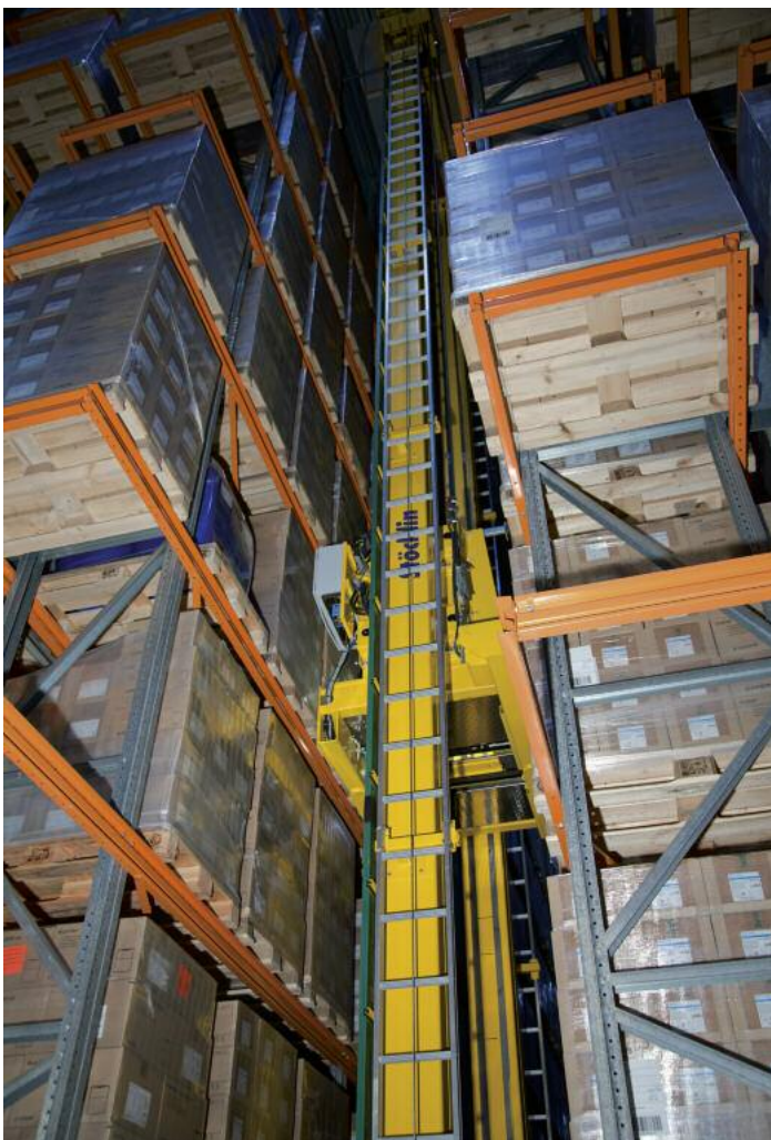
Automatisches Regalbediengerät Master 18T beim Auslagerprozess in der Regalgasse des Hochregalpalettenlagers
