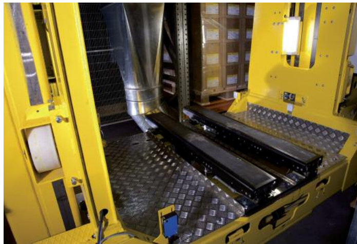
Die vier Regalbediengeräte des Typs ‚Master 18T‘ von Stöcklin sind vollautomatische, gassengebundene 2-Mast-RBGs
