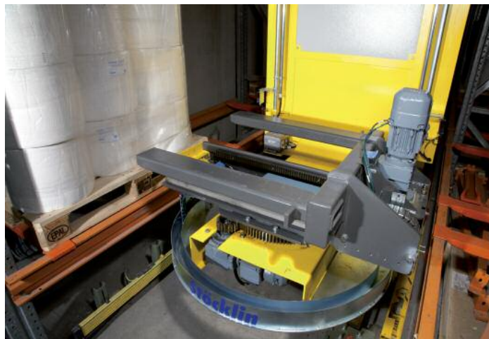
Lastaufnahmemittel des Stöcklin-Regalbediengeräts ‚Sigopick‘ mit automatischer Drehschubgabel
