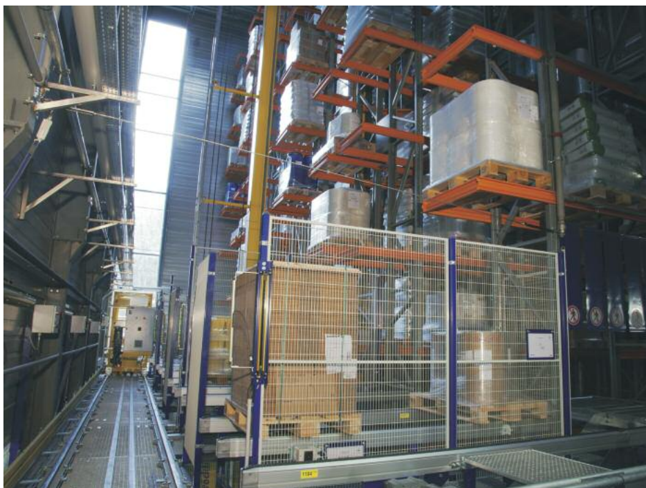
Verschiebewagen im Lagerkopf. In der Bildmitte das automatische Regalbedien- gerät des Typs ‚Master 18T‘ von Stöcklin Logistik mit einer Palette
