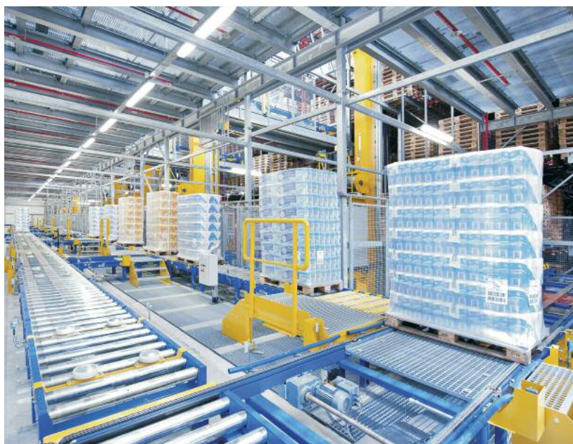
Der Warenausgang befindet sich auf der unteren Ebene, wo die Fördererzeugnisse die Waren sortiert nach Lkw-Ladung zur Versandhalle transportiert
