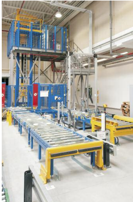
Auf der oberen Ebene werden die Waren ein-, auf der unteren ausgelagert
