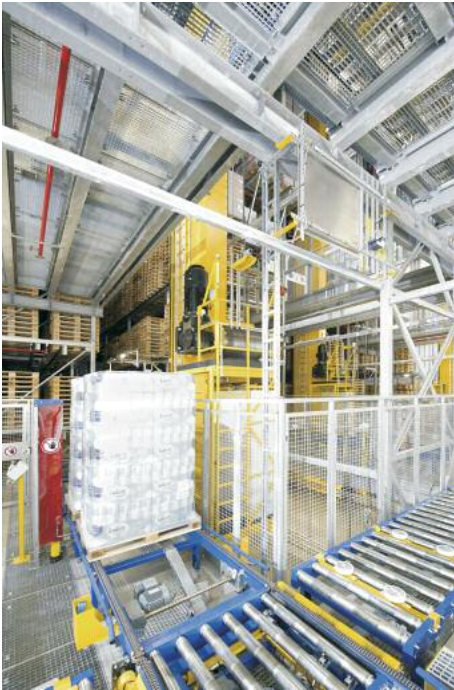
Übergabepunkt: Ein Regalbediengerät setzt eine Palette auf die Förderanlage
