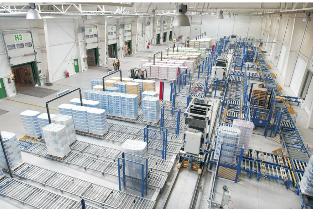
Im Warenausgang: Ketten- und Stauförderer, Dreh-, Roll- und Schwerkraftrollbahnen, Verschiebewagen und Palettenstapler sorgen für eine effiziente interne Logistik
