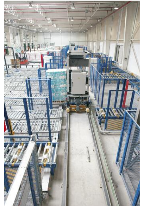
Drei Verschiebewagen im Warenausgang verteilen die Paletten auf die 40 Bahnen
