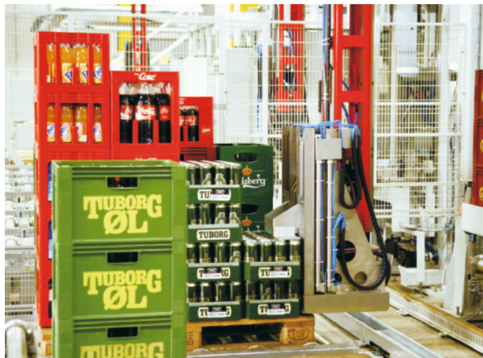
Vorkommissionierte Paletten werden bei großem Betrieb gelegentlich im automatischen Kastenlager kurzzeitig gepuffert
