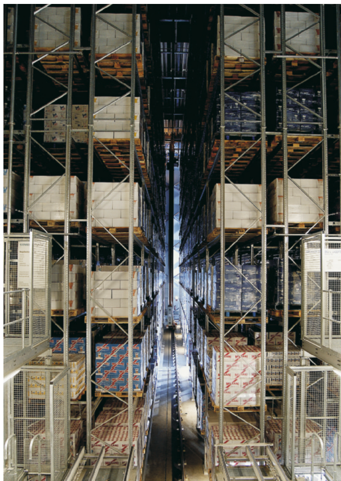
Nach der Erweiterung stehen dem Milchhof Magdeburg im automatisierten Lager 4 320 Palettenplätze zur Verfügung
