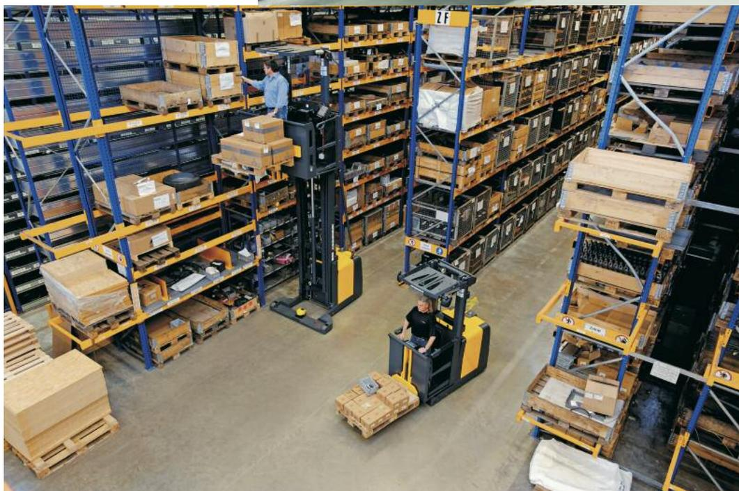
Die Jungheinrich-Kommissionierer vom Typ EKS 210/312 sind mit RFID-Technologie ausgerüstet. Dadurch kann das Lagerverwaltungssystem die Position der Stapler jederzeit genau definieren und das Fahrzeug automatisch an die richtige Stelle im Gang navigieren
