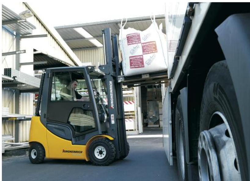
**Der hydrostatische Gegengewichtsstapler VFG 316s-320s in Tragkraftklassen bis 2 t wurde von Jungheinrich Anfang 2010 auf den Markt gebracht**
