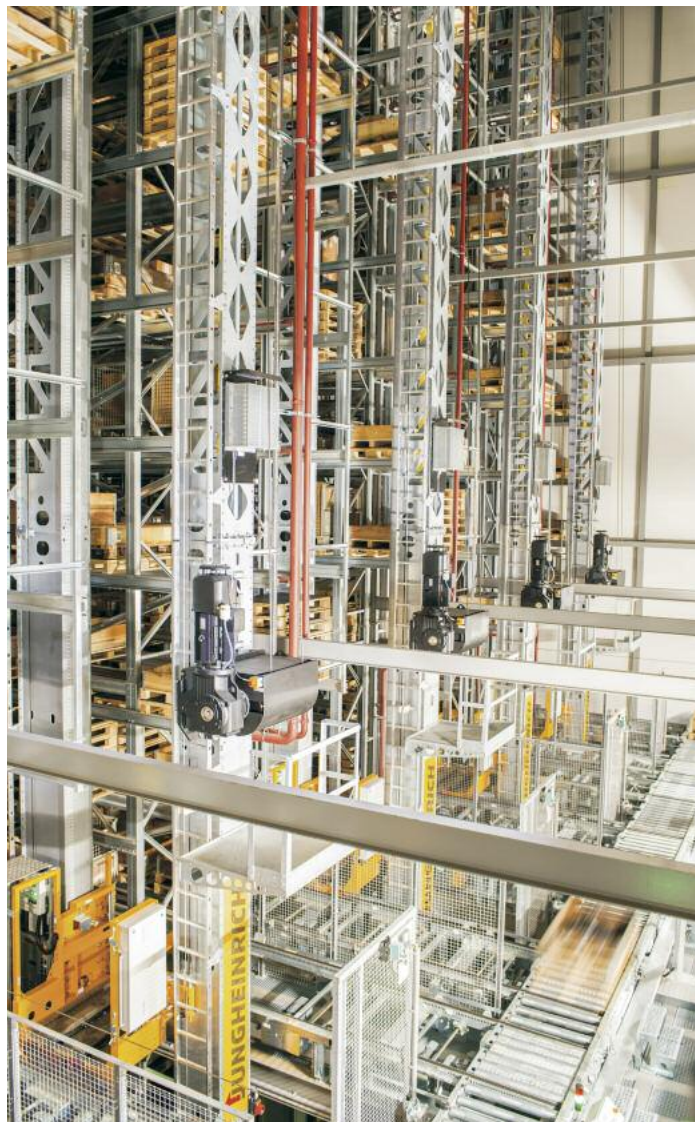
Ein 31 m hohes automatisches Hochregallager ist Bestandteil des neuen Ersatzteillogistikzentrums in Kaltenkirchen
