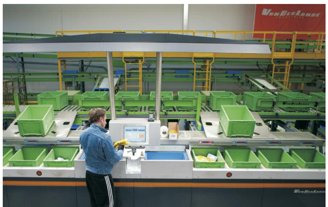
Teil einer Fördertechnikanlage: Die Kommissionierstation Pick@Ease von Vanderlande für das Picken nach dem Prinzip ‚Ware zum Mann‘. Das Bild zeigt eine Implementation bei Sacchi
