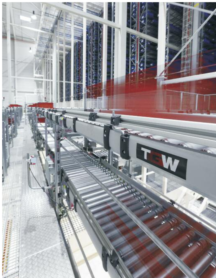
TGW realisiert dynamische Fördersysteme, vor allem zur Versorgung von Kommissioniersystemen
