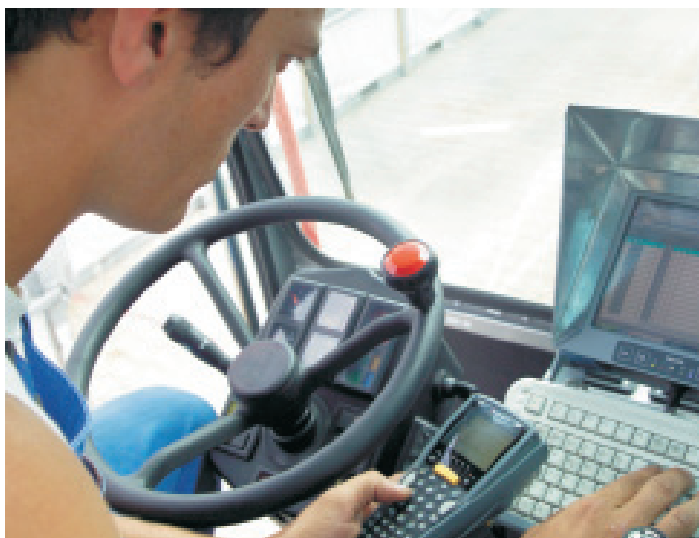
Alle Informationen im Blickfeld: Neben dem Lenkrad des Staplers befindet sich das Stapler-Terminal C8 von Noax
