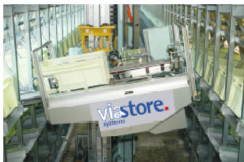
Die Pick-by-Light-Kommissionierplätze werden durch automatische Regalbediengeräte mit Nachschub versorgt
