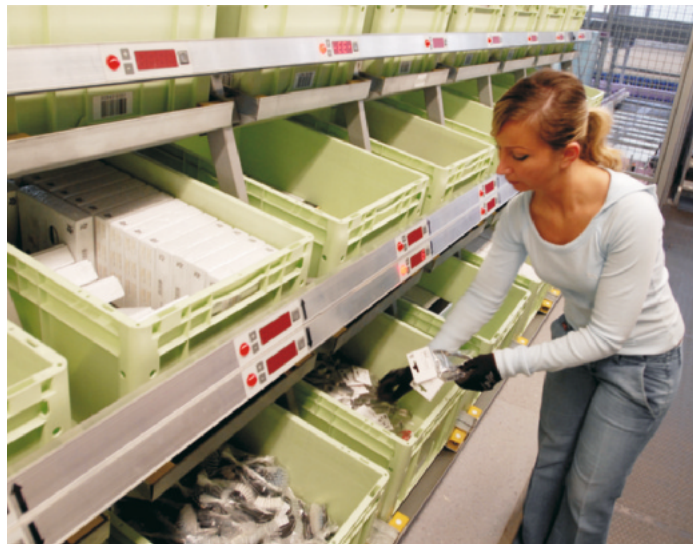
Pick-by-Light-Kommissionierung von A-Artikeln im Lager für Schnelldreher im Obergeschoss bei WMF in Geislingen
