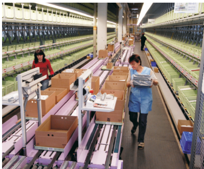
In der Pick-by-Light-Anlage wird in die Kartons kommissioniert, die nur noch versandfertig gemacht werden müssen
