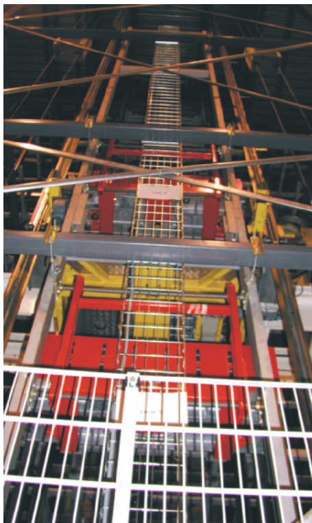
Mit den Levmatic-Aufzügen wechseln die VM-Fahrzeuge zwischen den verschiedenen Regalebene hin und her
