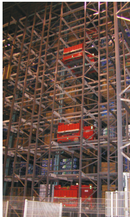
Mitunter halten sich alle vier im Lager vorhandenen Magmatic-Regalfahrzeuge in einer einzigen Regalgasse auf
