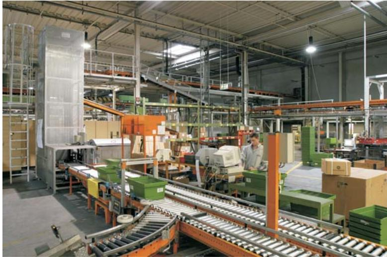
**Vorzone des automatischen Kleinteilelager (AKL) mit einzulagernden Kunststoffbehältern. Die Fördertechnik transportiert sie zu den einzulagernden Regalbediengeräten**
