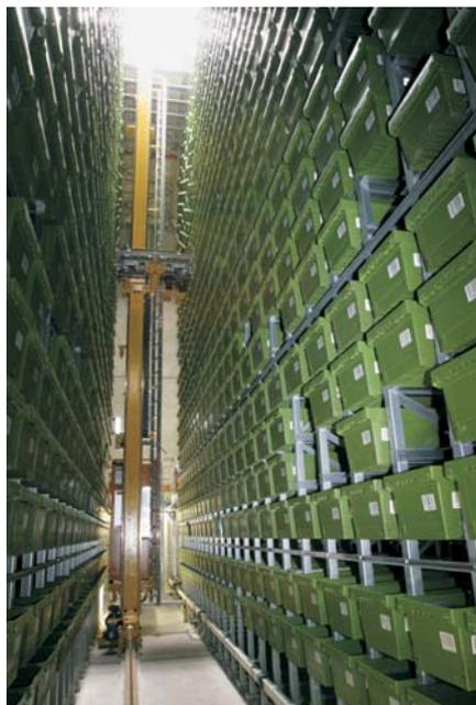
**Das automatische Kleinteilelager, in dem bis zu 26 000 Behälter Platz finden**
