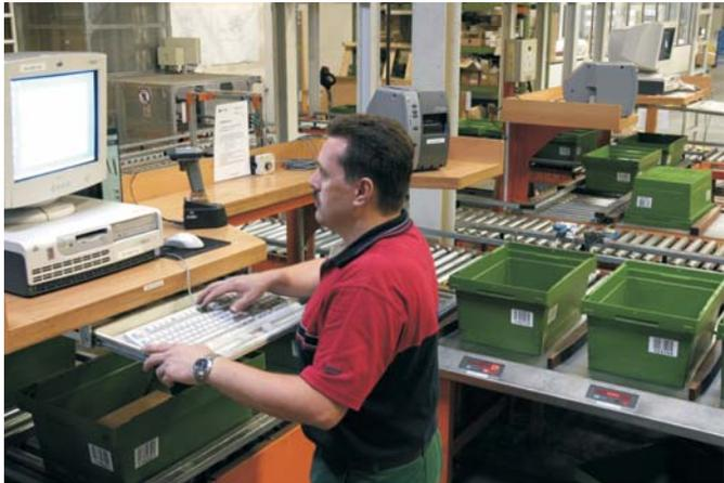
**Pick-to-Light-Kommissionierplatz für aus dem automatischen Kleinteilelager kommende Kleinteilebehälter**
