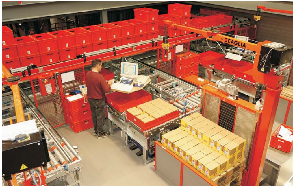
Die im Wareneingangsbereich auf Paletten eintreffenden Ladungen werden umgepackt, um im automatischen Kleinteilelager eingelagert werden zu können
