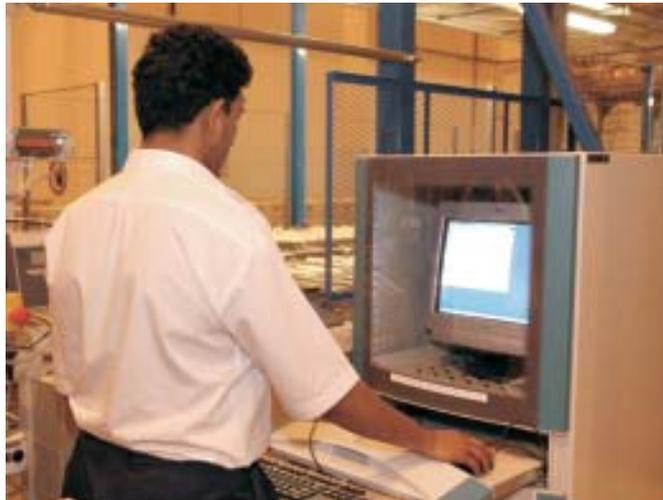
**Die Logistik wird über den Materialflussrechner und das übergeordnete Warehouse-Management-System gesteuert**
