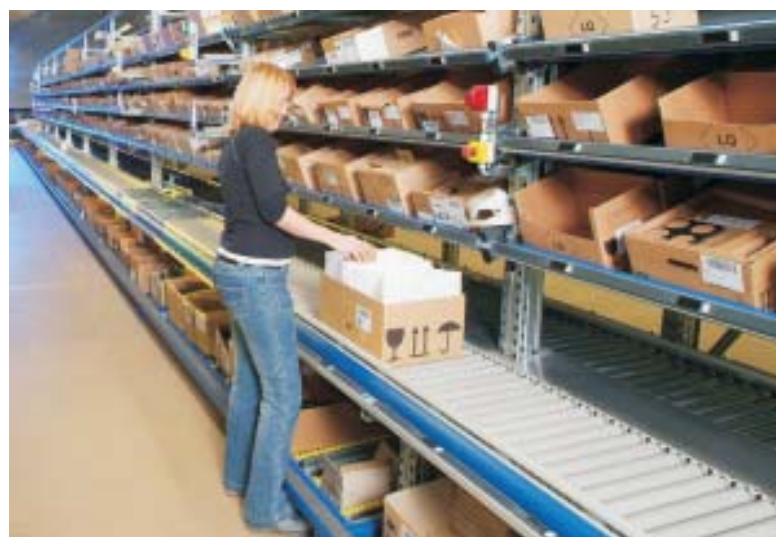
Pick-by-Light-Kommissionieranlage mit einer Rollenförderstrecke, über die die Arbeitsplätze mit Behältern versorgt werden
