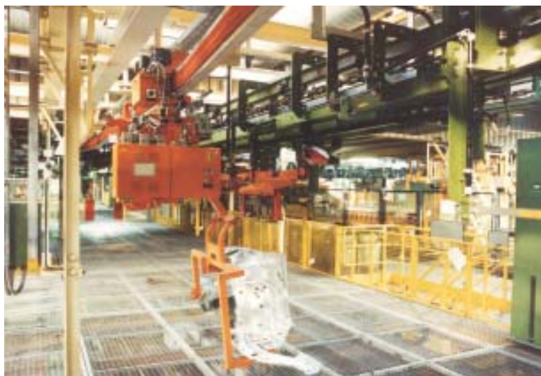
Elektrohängebahn-Fahrzeug mit Handling-Vorrichtung für die Handhabung von Chassis-Teilen in der Automobilindustrie
