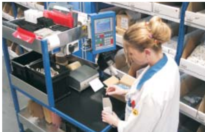
Kommissionierwagen mit mobilem Datenterminal, mobilem Drucker und Scanner bei Arrow-Electronics in Venlo
