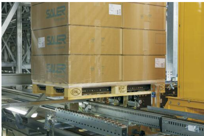
Als Lastaufnahmemittel für doppeltiefes Ein- und Auslagern dienen Palettenteleskopgabeln für jeweils eine Ladeinheit
