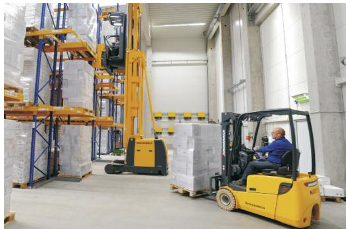
**Ein mit Handheld-Computer ausgestatteter Elektrodreiradstapler EFG 113 bringt eine Palette zur Übergabestation**
