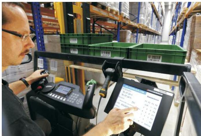
**Der Fahrer des Kommissionierstaplers bei Warimex erhält seine Kommissionieraufträge direkt auf das Fahrzeugterminal**
