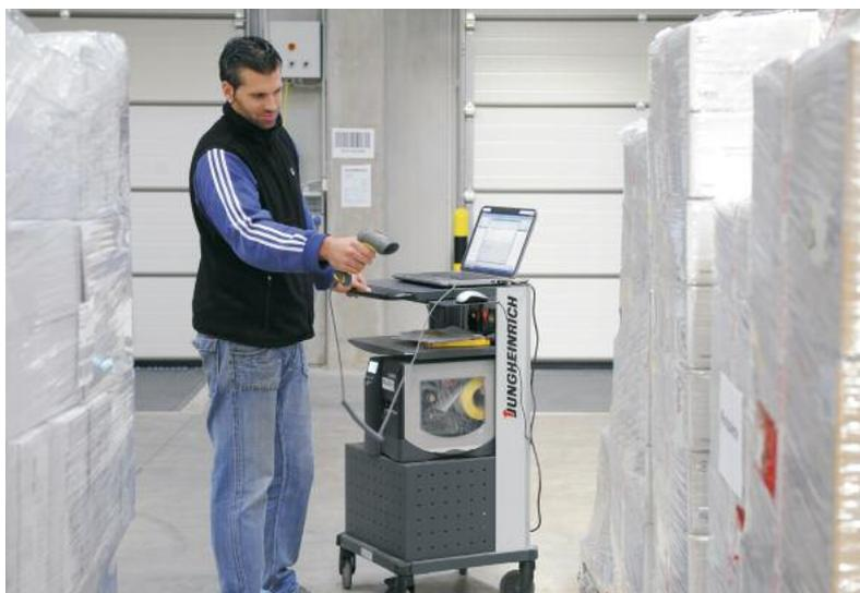
**Mobiler Arbeitsplatz mit Notebook für den Zugriff auf das WMS, leistungsfähigem Akku, Etikettendrucker und Barcodescanner**
