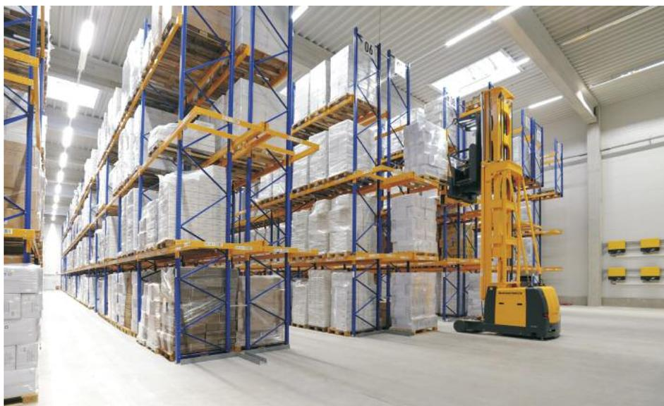
**Der Kommissionierdreiseitenstapler EKX 515k wird in den sechs Gassen des Schmalganglagers induktiv geführt. Er ist mit RFID-Lagernavigation ausgestattet**
