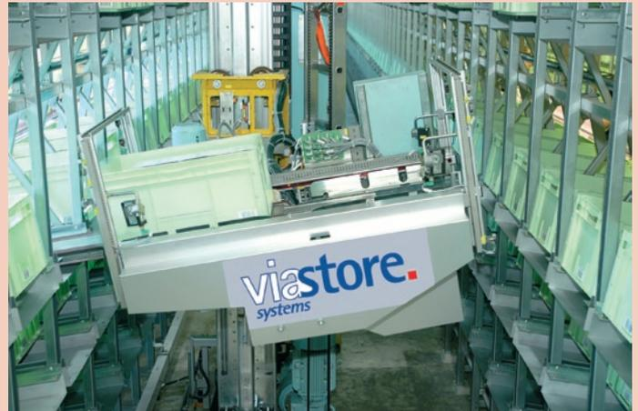
Bild 4: Mithilfe eines kippbaren Lastaufnahmemittels kann das Regalbediengerät leere Behälter in den Kommissionierbahnhöfen automatisch austauschen
