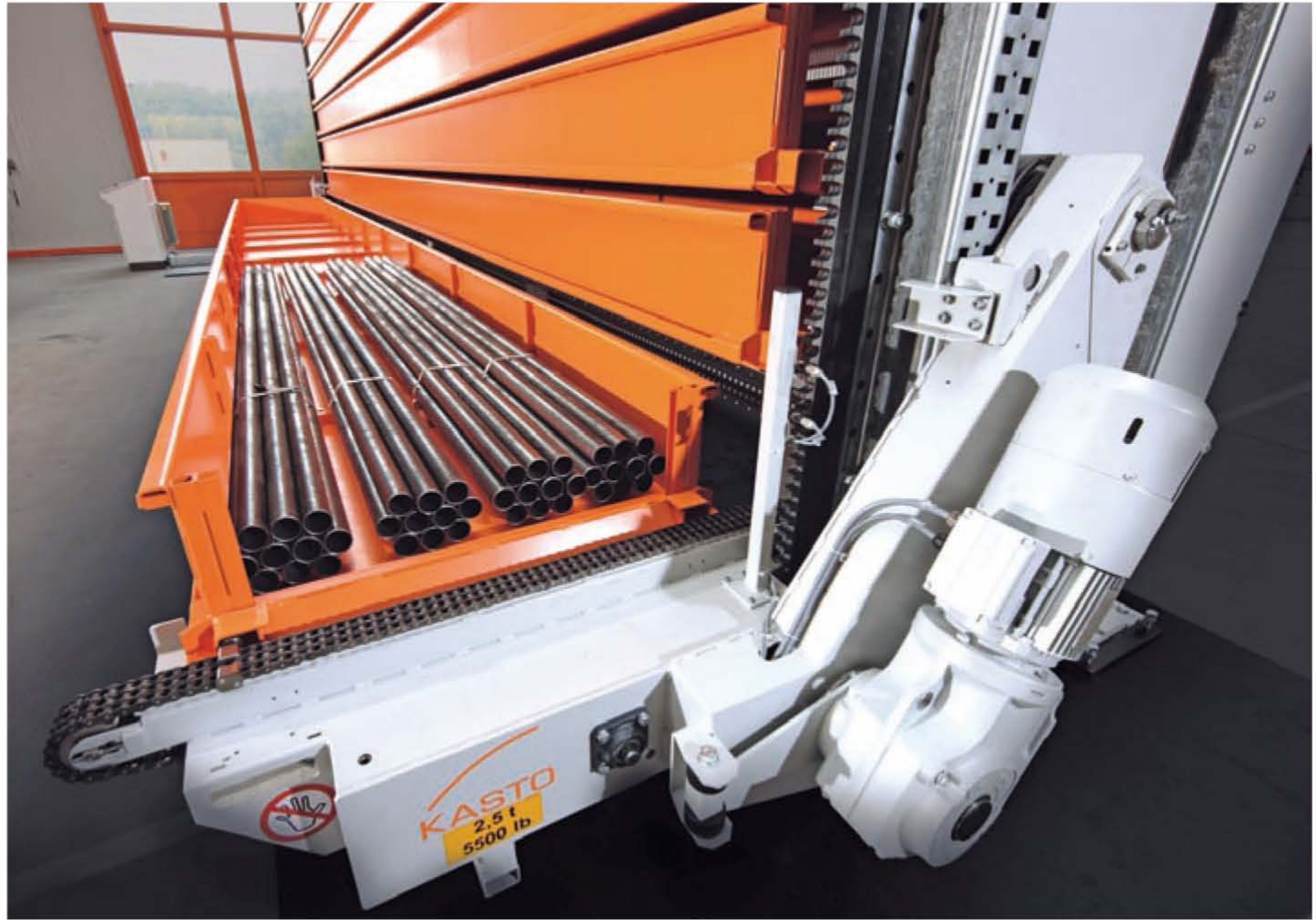
Bild 2: Hubtraverse mit Langgut-Kassette und Hubwerksantrieb über eine Kettenzahnstange
