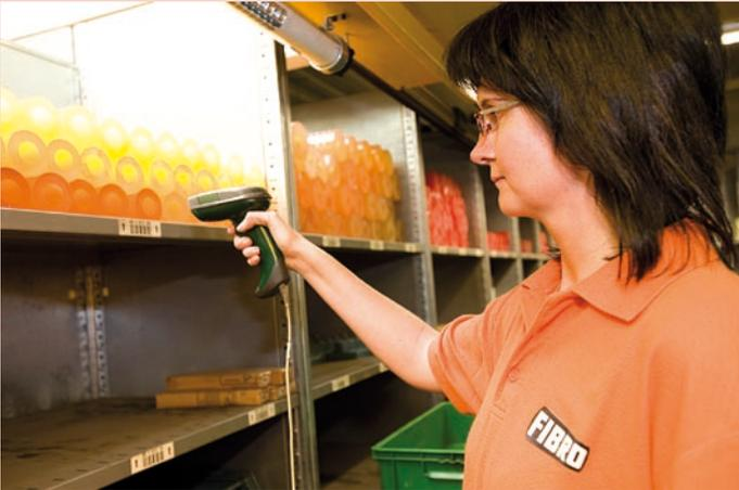
Bild 3: Funkterminals auf den viasprint-Regalbediengeräten unterstützen die softwaregeführte „Mann zur Ware“-Kommissionierung
