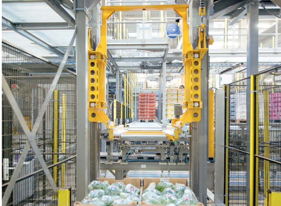
Die Fördertechnik dient sowohl als Zuführ- als auch als Staustrecke und wird jeweils weitgehend artikelrein mit Paletten bestückt (Bilder: Dematic)
