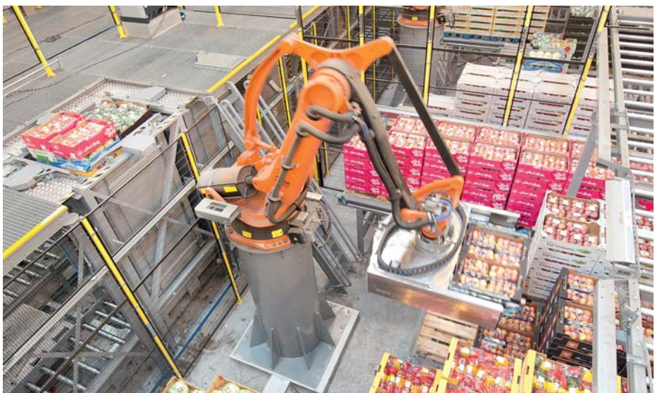
Für ein besseres Handling der Güter sind die Roboter mit speziellen Kombi-Greifern ausgestattet. Die Kommissionierung erfolgt in die Palettenstapelhilfe (links)
