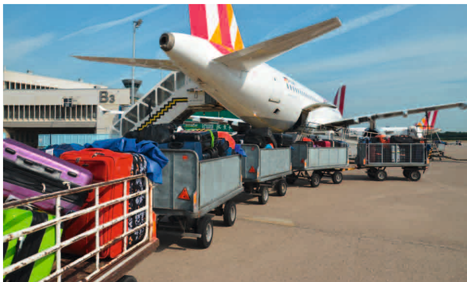
1 Die Gepäckwagen werden an einem Sammelpunkt zu Wagenzügen zusammengestellt und von dort zu den Flugzeugen transportiert.
