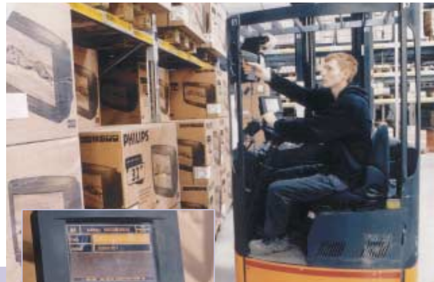
Beleglos wird beim Elektro-Großhändler Kluxen kommissioniert. Die Stapler sind mit Datenfunkterminals ausgestattet, auf denen die Fahrer die Aufträge ablesen und bestätigen. Das Materialfluss-Management-System von Still koordiniert die Stapler und die Mitarbeiter mit ihren Handhelds in der Fachbodenregalanlage (Bild: Still)
