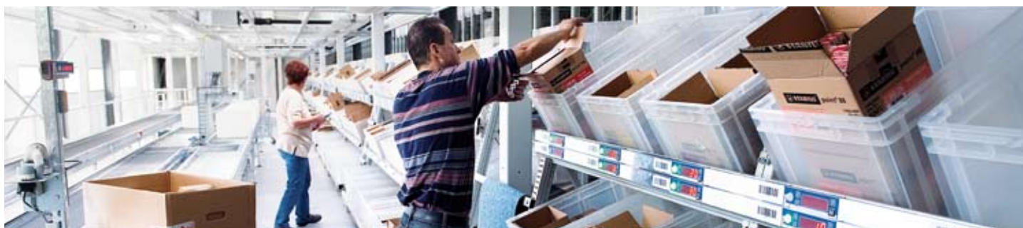
Mit der Pick-by-Light-Anlage verwirklicht STABILO erstmals das Prinzip Mann zur Ware.
