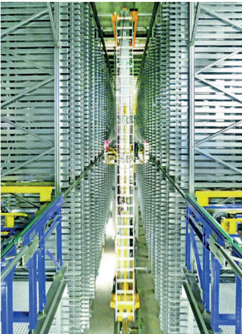
Mit geschlossenem Lastaufnahmemittel können die Zweimaster bis zu 300 kg (SMC 2 XL) im AKL bewegen.
