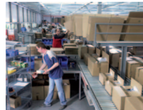
Nach der LFS-gesteuerten Kommissionierung gelangt die verpackte Ware auf eine halbautomatische Packstrasse.
