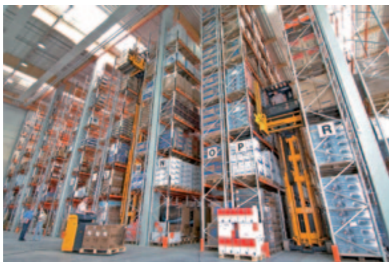
Seit der Einführung des Lagerverwaltungssystems werden bis zu 1200 Einlagerungen, 2000 Umlagerungen und 12000 Auslagerungen pro Tag durchgeführt.
