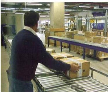
Mit dem Lift fahren die gepackten Kartons aus der Kommissionierzone in den Versand im Erdgeschoss.
