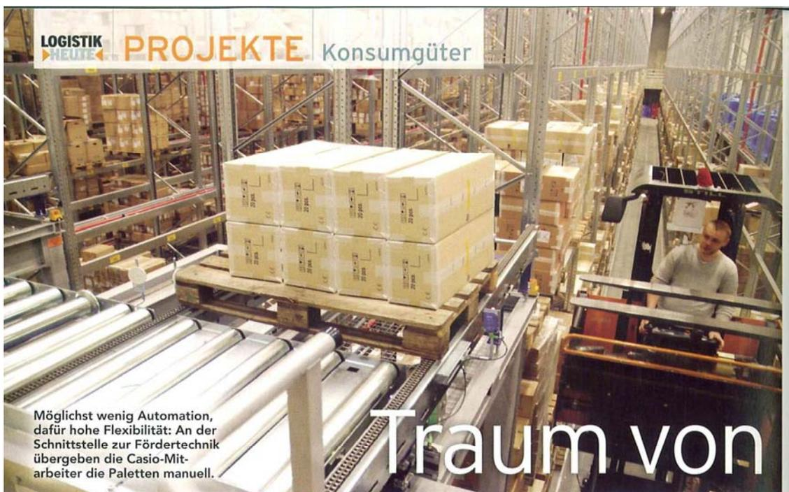
Möglichst wenig Automation, dafür hohe Flexibilität: An der Schnittstelle zur Fördertechnik übergeben die Casio-Mitarbeiter die Paletten manuell.
