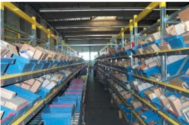
Die bereits bestehende Pick-to-Light-Anlage wurde an die neue Software angebunden.
