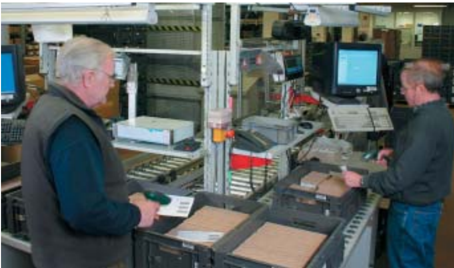
Nach dem Wareneingangs-Scan steuert das WMS bei Weidmüller die Ziellagerortfindung und Platzvergabe der Artikel.
